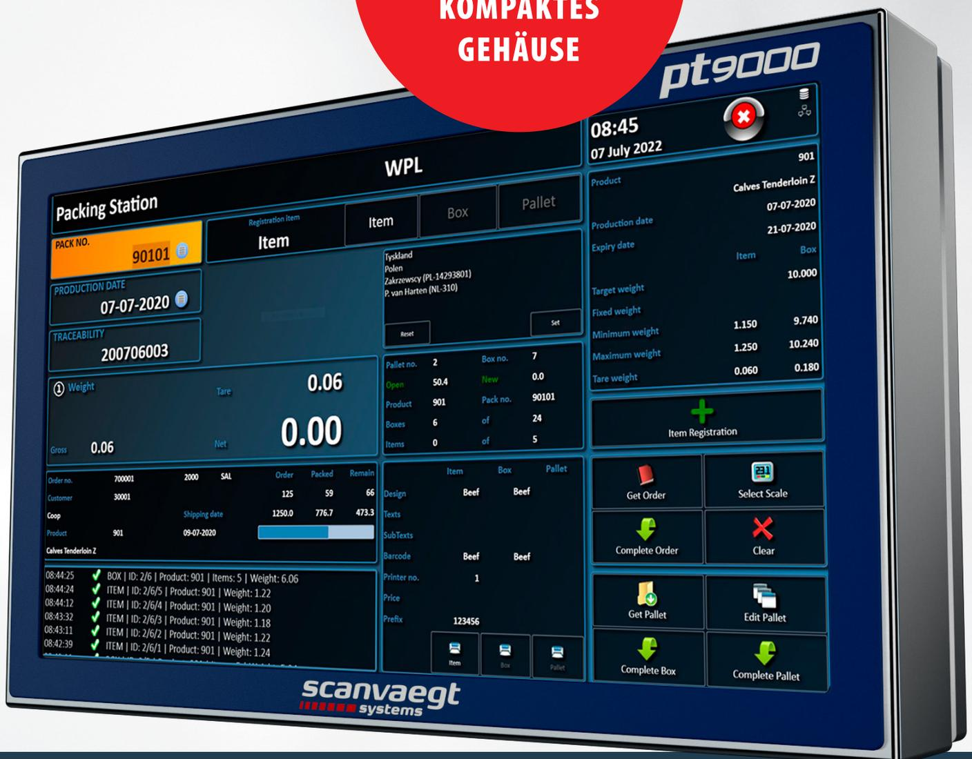
Der Scanvaegt pt9000 mk4 ist ein schneller, leistungsstarker und benutzerfreundlicher Industriecomputer mit 18,5" Touchscreen für Aufgaben wie die Produktionssteuerung, Auftragsverpackung, Versand, Datensammlung und Überwachung.
